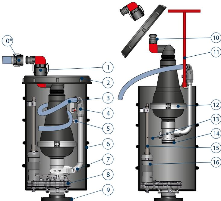
Entnahme des Ventileinsatzes unter Betriebsdruck.
