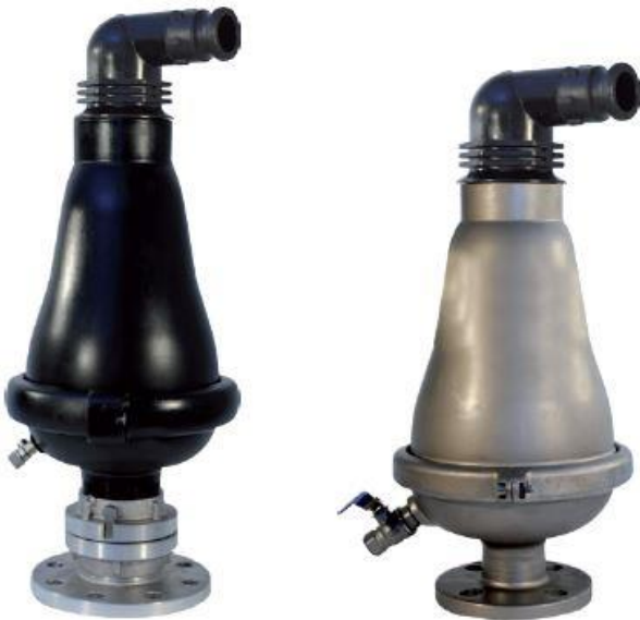
Abb. Links: D-025-L-R3-PAGF-PN16 mit Storz-B-Kupplung VA auf Flansch DN80, rechts D-025-L-VA-DN50
