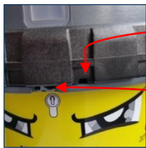
Abbildung 1: Gehäuse noch nicht nach Schutzart IP68 dicht verschlossen
