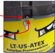
Abbildung 2: Gehäuse dicht verschlossen (IP68)
