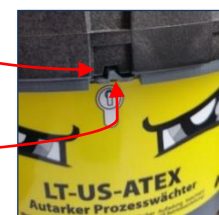
Abbildung 2: Gehäuse dicht verschlossen (IP68)
